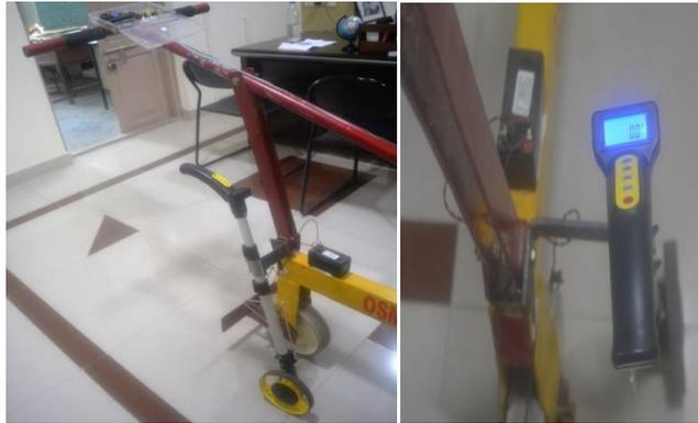
Fig. 4 Hand ODOMETER Wheel
